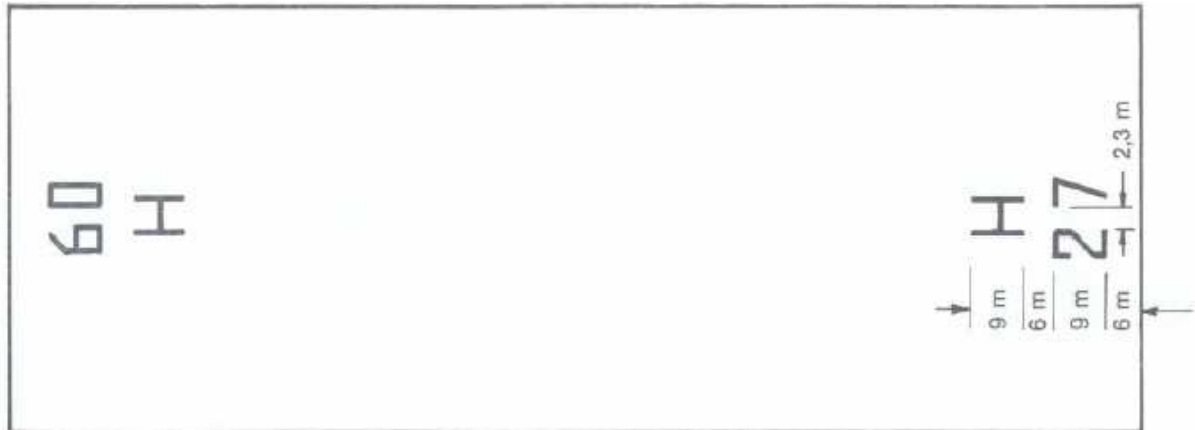
Figure 5-3. Marque d'identification d'aire d'approche finale et de décollage
