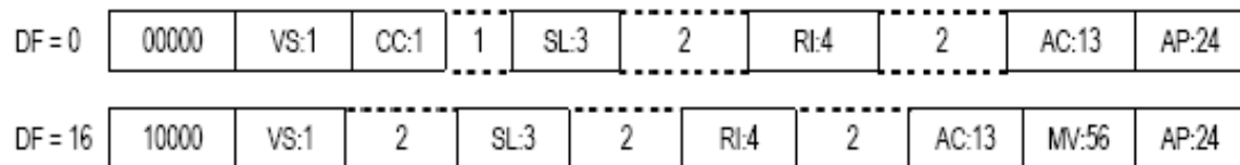
Figure 4-1. Formats de surveillance et de communication utilisés par l'ACAS
