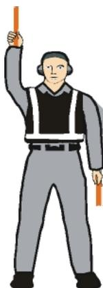
Lever la main droite au-dessus de la tête, bâton pointant vers le haut, et bouger le bras gauche, bâton pointant vers le bas, en direction du corps.
