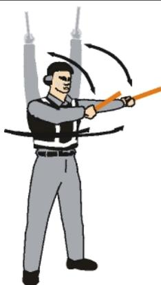
Tendre les bras vers le haut, puis les abaisser vers le côté du corps, en pointant les bâtons dans la direction du signaleur suivant ou de l'aire de circulation
